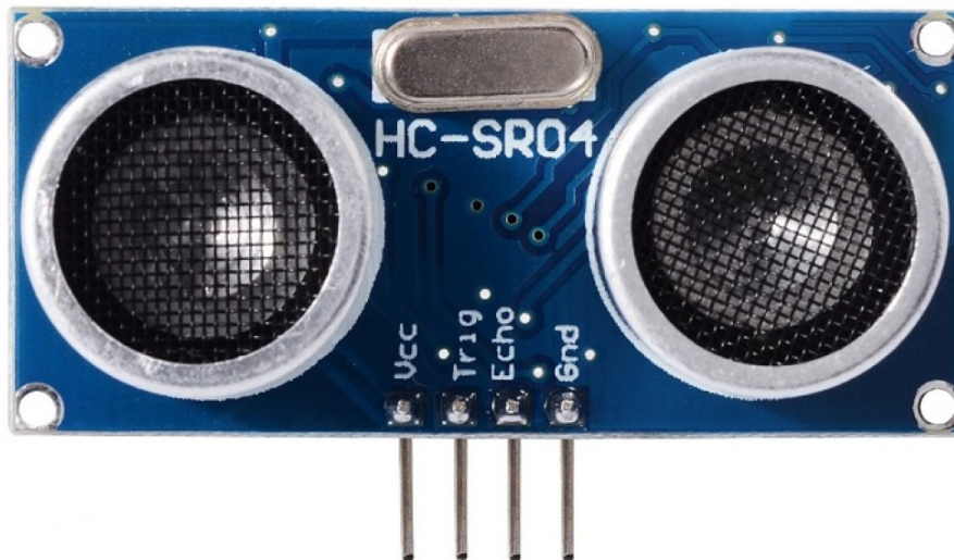
Abbildung 17: Der benutzte Sensor 1) Spannung 2) Trigger Pin 3) Echo Pin 4) Erdung
