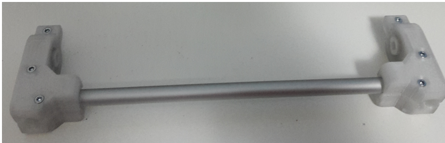
Abbildung 1: Hinterachse des ursprünglichen Aufbaus
