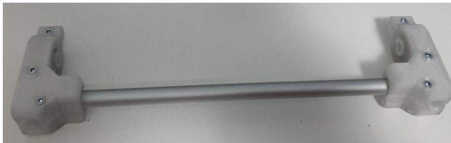
Abbildung 1: Hinterachse des ursprünglichen Aufbaus
