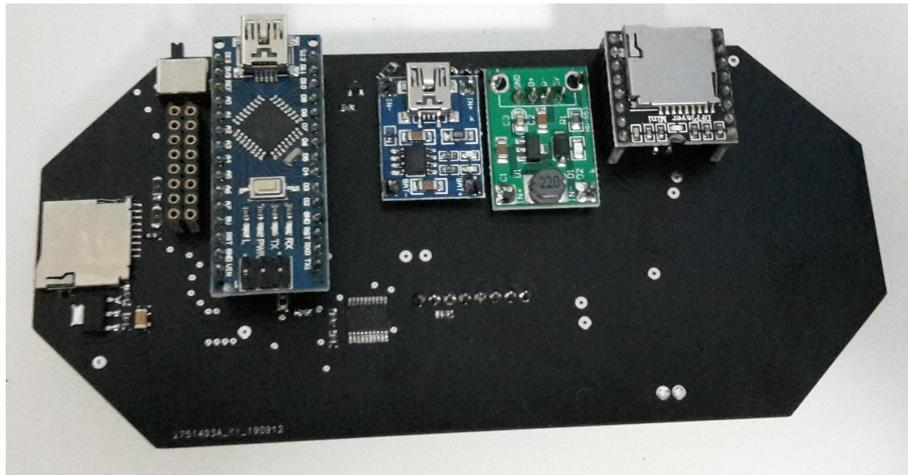
Abbildung 7: Fernsteuerung hinten
