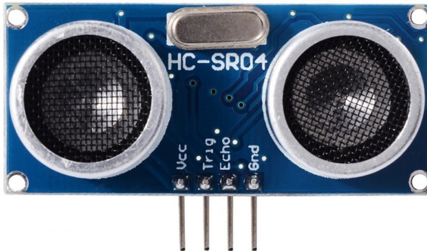
Abbildung 20: Der benutzte Sensor [15] 1) Spannung 2) Trigger Pin 3) Echo Pin 4) Erdung
